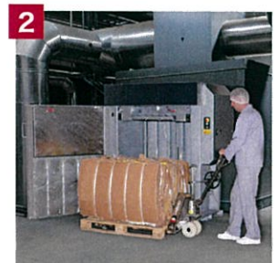
2. 簡単なバールの取り扱い
